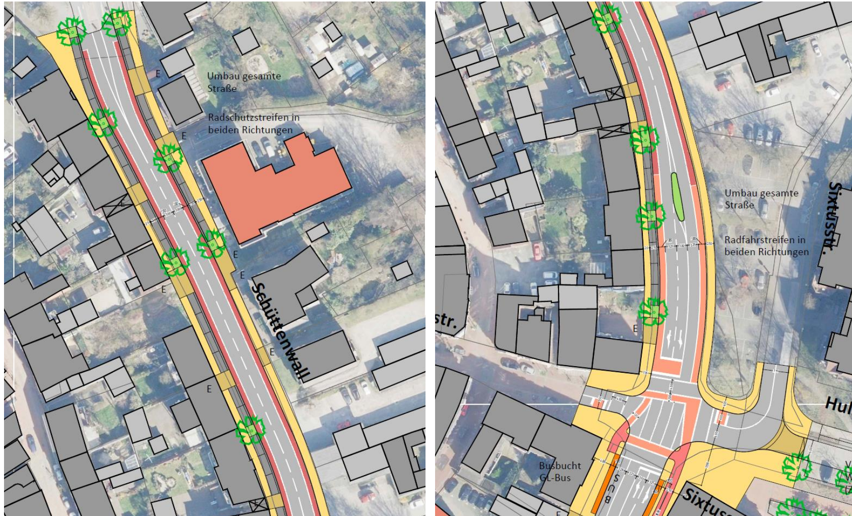
Abb. 3.3.3-6 Abschnitt 4: Schüttenwall Variante B mit vorwiegend Radschutzstreifen
