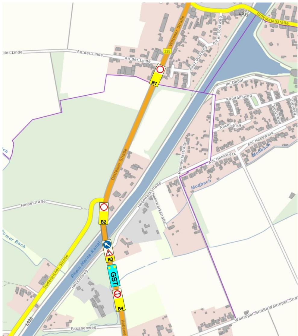
Nachdem die Sperrungen erfolgt sind, fahren das Bfz3, der GST und das Bfz4 zu der Kreuzung Wittener Str. / Provinzialstr. / Dortmunder Str. Die Sperrungen werden aufgehoben. Bei Brückenaufgaben halten das Bfz3 und das Bfz4 so viel Abstand, dass eine ggf. angeordnete Alleinfahrt über die Kanalbrücke gewährleistet ist.
