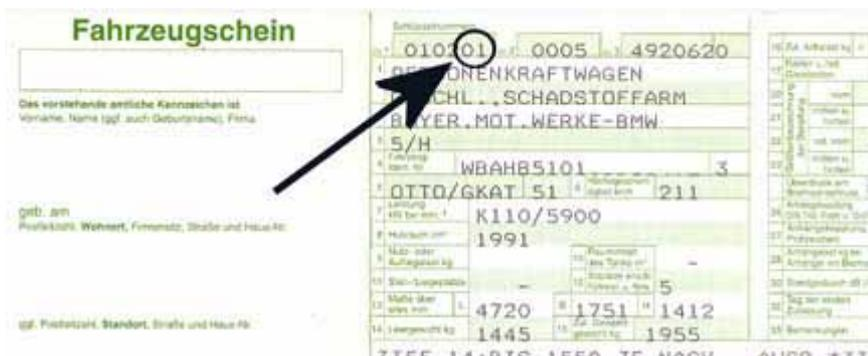
Abb. 5.3.1/3 Position der Schlüsselzahlen im Kraftfahrzeugschein die vor dem 1.10.2005 ausgestellt wurden.
